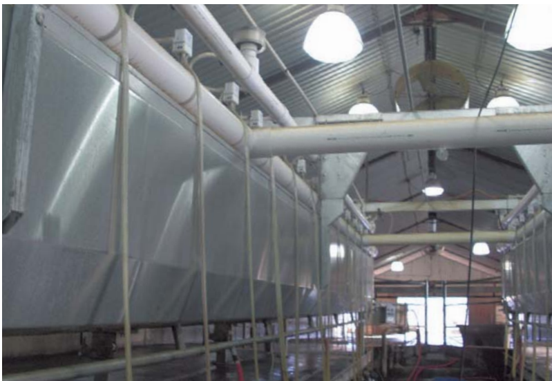
Het CoPulsation melksysteem ingebouwd in een grote melkstal.
