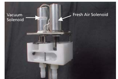
CoPulsation werkt met twee kleppen. De ene zorgt voor vacuüm in de pulsatorruimte en de andere voor atmosferische lucht. De beide kleppen worden om en om geopend, waarbij er dertig milliseconden zit tussen het sluiten van de ene en het opengaan van de andere. Zo kunnen de lucht en het vacuüm niet vermengd worden.
